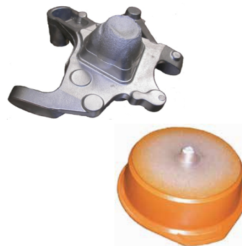
Piezas Fundidas Con Colada Basculante Usando Alimentación en la Mazarota
